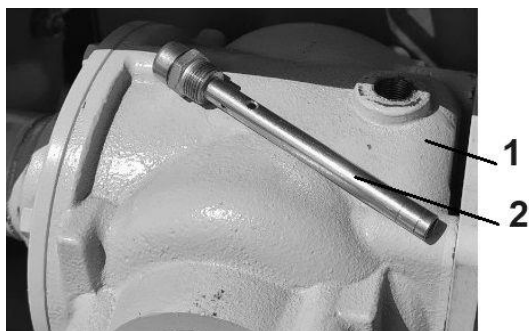
Rysunek 8. Poziom oleju w przekładni kątowej: 1 – przekładnia kątowa, 2 – korek z bagnetem
