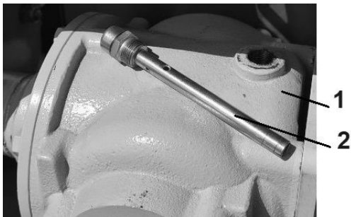
Abbildung 8. Ölstand im winkelgetriebe: 1 – winkelgetriebe, 2 – stopfen mit messstab
